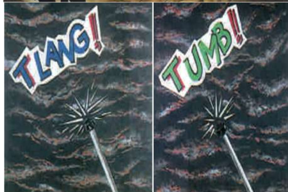
SONIDO METALICO: CERRO FIRME SONIDO HUECO: ROCAS SUeltas
