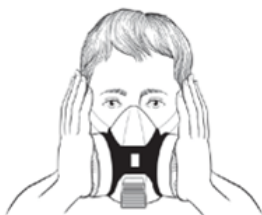
Prueba de Presión Negativa Máscara de Rostro Completo (Filtros con ajuste tipo rosca)
