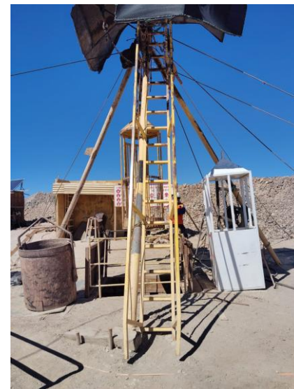
Figura 10: Sistema de extracción vertical Mina Rosario
