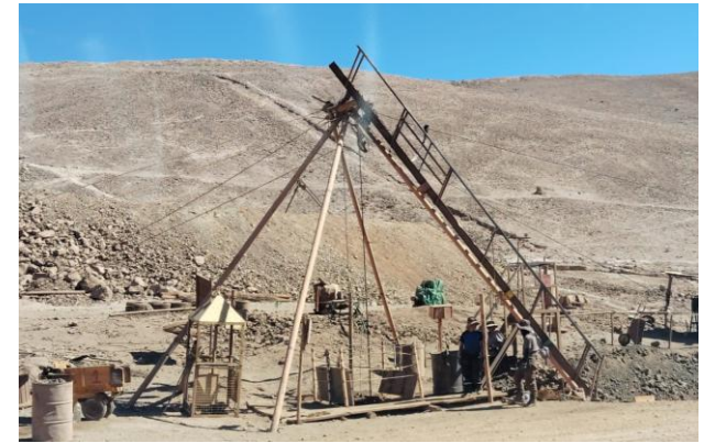
Figura 2: estructura de extracción vertical 4 soportes pequeña minería.
