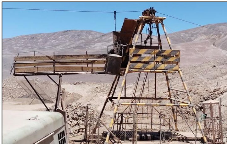
Figura 9: Sistema de extracción vertical Mina Rosa
