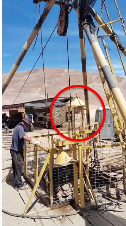
Figura 5: Medida de seguridad para cerrar entrada de a pique .
